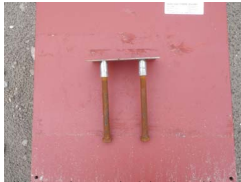
Bild 4.2 Variante zweier Schraubanschlüsse mit Schablone
