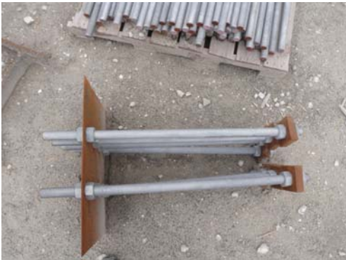
Bild 1.1 Gewindebolzenanker mit Schablone und Fußplatte
