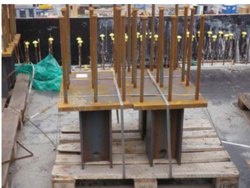
Bild 3.1 Ankerplatte mit neun Kopfbolzen
